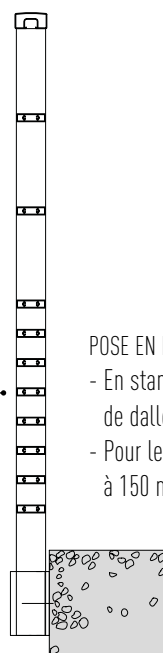
POSE EN NEZ DE DALLE
